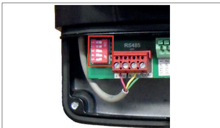
Posição dos switches para a pilotagem por iQPUMP
