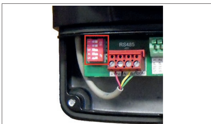
Posição dos switches para a pilotagem pela interface do utilizador
